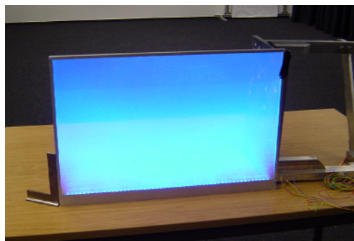
Abb.2 flächiger Lichtleiter mit LED-Einkopplung
