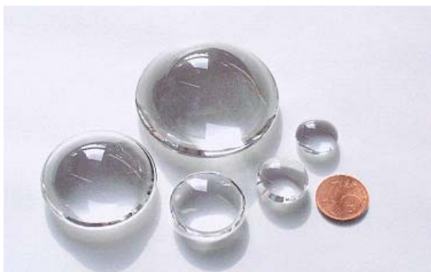
Abb. 2 Precision Gobs, Vorformen für asphärische Blankpresslinge
