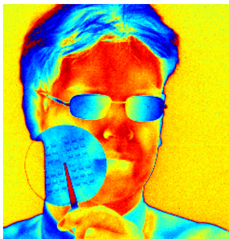
Abb. 1 Infrarot-Aufnahme einer Person mit Brille aufgenommen mit einer PtSi-Kamera im 3-5 \mu m Spektralbereich. Die Silizium-Scheibe vor dem Gesicht ist durchsichtig.
