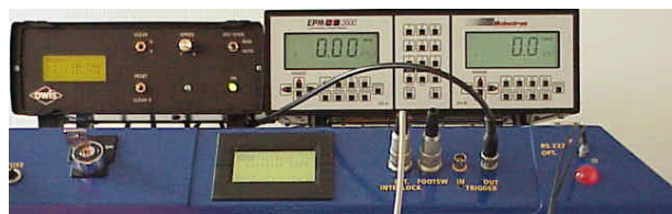
Abb. 2 Geräte des Messsystems: Excimerlaser (unten), Goniometersteuerung (links), Energiemessgerät (rechts)
