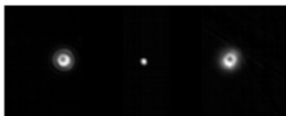
Abb. 3 Gemessene Punktbildfunktion, fokussiert (Mitte), defokussiert (links, rechts), Objektiv Zeiss 63/1.4
