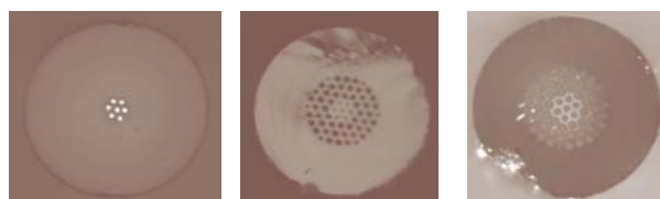
Abb. 1 Mikroskopaufnahmen germaniumdotierter Fasern; links: voll kollabierte Referenzfaser (Tab.1: Faser K); Mitte und rechts: PCF mit hohlstrukturiertem Kern und Mantel und unterschiedlichen d/\Lambda (Tab.1: Faser A bzw. B;)
