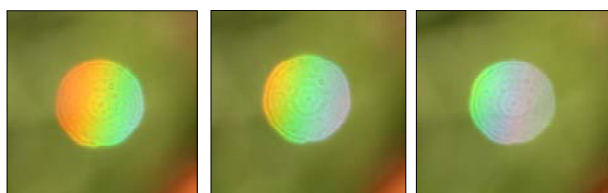
Abb. 5 Mit der Methode der Defokussierung (unscharfe Aufnahme in Makro-Einstellung) gewonnene Farbspektren. Der Abstand der Kamera vom Tropfen war zu klein, um alle Farben in einem Bild zu erfassen. Von Bild zu Bild wurde die Kamera leicht verschoben und so das Spektrum abgefahren.
