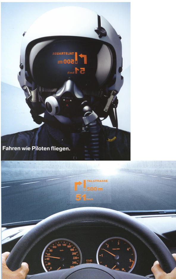
Abb. 1 Die Idee des Head-Up Displays: Wie ein Pilot soll der Autofahrer wichtige Information der Instrumente in die Windschutzscheibe eingespiegelt sehen
