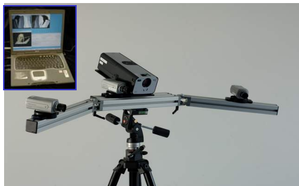
Abb. 1 Topometrischer Messkopf bestehend aus einem DLP-Videoprojektor für die Streifenprojektion und drei hochauflösenden Farb-CCD-Kameras für die Bilderfassung. Die Aufzeichnung erfolgt parallel mit den drei Kameras, wobei die Bilder der mittleren mit denen der äußeren jeweils als Stereopaare ausgewertet werden.
