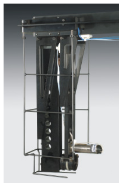
Abb. 3 Der optische Umlenkklift: Vom Messobjekt kommend passiert das Licht zunächst den Analysator. Über eine Kombination aus Hexagon- und 90^\circ -Prisma wird das Licht zum Detektor geführt.
