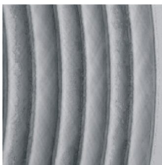
Abb. 4 Grauwert-codiertes Höhenprofil der äußeren Zonen einer diffraktiven Mikrolinse gemessen mit konfokaler Mikroskopie. Die dargestellte Bildgröße beträgt 80 x 80 \mu\text{m}^2 .
