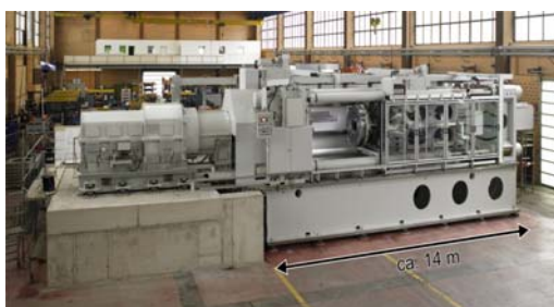
Abb. 1 Bild der neu entwickelten Reibschweißanlage
