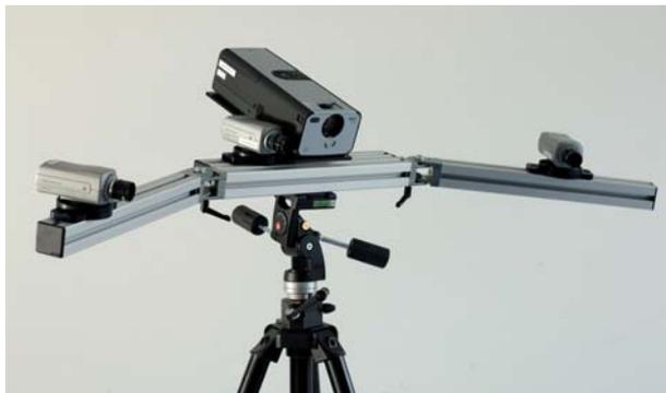
**Abb. 1** Aufbau des topometrischen Messsystems. Das 3-D Koordinatenmesssystem basiert auf zwei oder mehr hochauflösenden CCD-Kameras und einem Standard-Videoemitter für die Lichtmusterprojektion.
