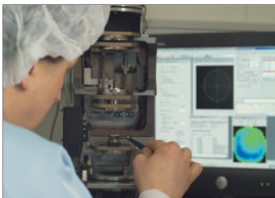
Vermessung jeder Einzellinse gegen einen „Null-Linsensatz“
