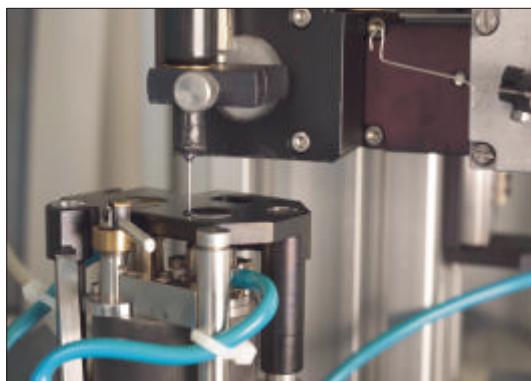
Automatisches Zentrieren und Einkleben
