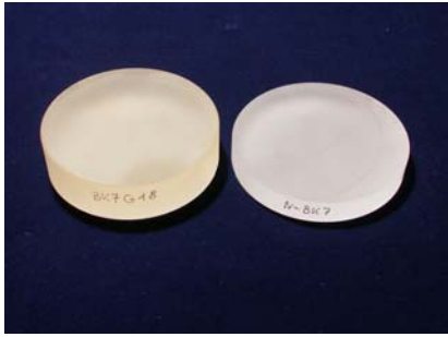
Abb. 3 BK7G18 (links) im Vergleich zu N-BK7 (rechts).
