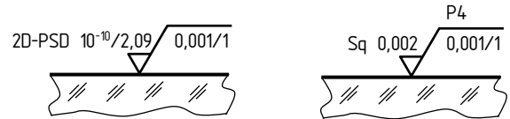
Abb.1: Vorschlag für die Darstellung der Oberflächengüte spiegelnder Oberflächen mittels 2D-PSD (links) und des quadratischen Flächenmittenrauwerths Sq (rechts) nach ISO 10110-8
