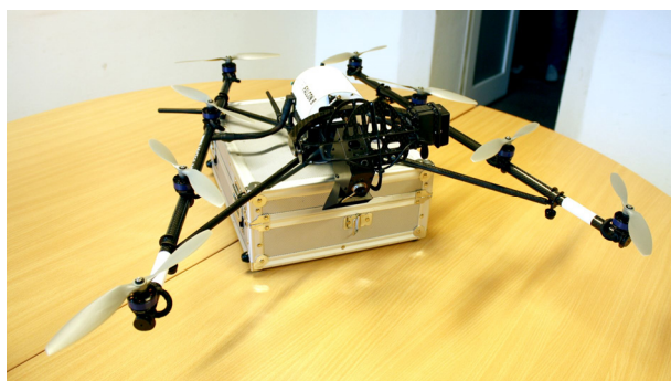
Abb. 1 Unbemanntes Kleinflugzeug (UAV) mit einer für Octokopter typischen maximalen Traglast von 300 g.
