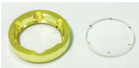
Abb. 3 Globale Metallisierung der Fassung mit Kegelgeometrien (links) und lokale Metallisierungspads auf Linse (rechts)
