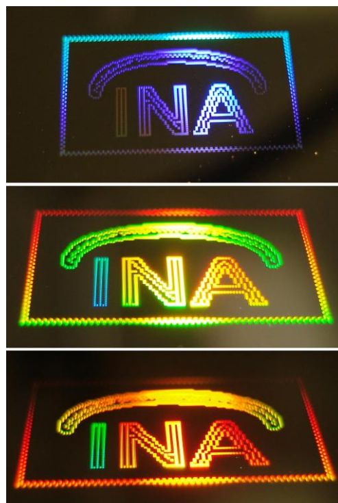
Abb. 6: Farbig leuchtende DOE Struktur, die mit dem beschriebenen Verfahren hergestellt wurde. Die winkelabhängige Änderung des Farbeindrucks und die flächige Darstellung sind gut zu erkennen.
