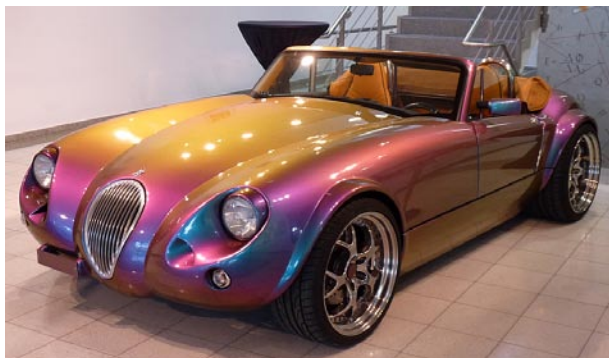
Abb. 1 Fahrzeug mit einer goniochromatischen Effektlackierung. Der winkelabhängige Farbeindruck umfasst das gesamte visuelle Spektrum.
