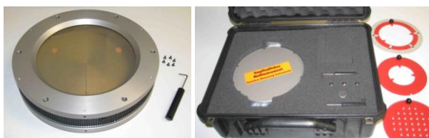
Abb. 1 Prüfling in Metallfassung (links) und Transportkoffer mit Umweltsensor und Masken (rechts)
