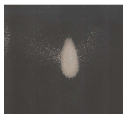
Abb.3 Sandstrahl am schräg stehenden Spalt. Der weiße Fleck in der Mitte des Bogens ist die nullte Ordnung, die ungebeugt durch den 1,57 mm breiten Spalt geht
