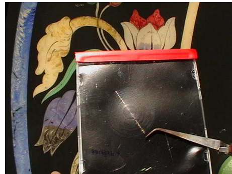
Abb.5 Kratzhologramm nach Wheatstone[1]
