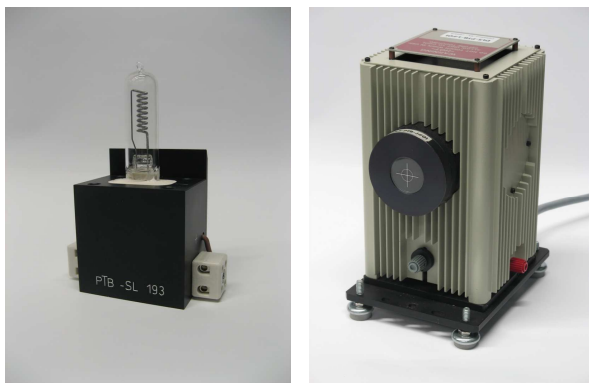
Abb. 3 Typische Sekundär- und Transfornormale für spektrale Bestrahlungsstärke links: 1000 W Quarz-Halogenglühlampe (Typ FEL) rechts: 30 W Deuteriumlampe (Typ PTB-DLS)
