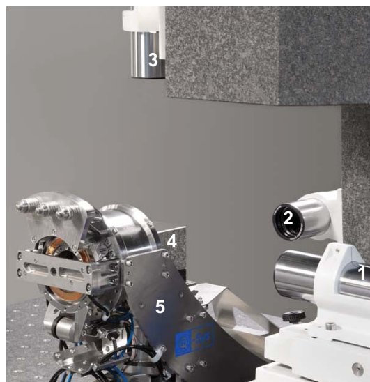
Abb. 1 Hauptkomponenten des SAAC. 1: zu kalibrierender AK, 2 & 3: horizontaler und vertikaler Referenz-AK, 4: Reflektorwürfel, 5: Kippsystem. Die AK sind kartesisch angeordnet und tasten jeweils die ihnen zugewandte Seite des Reflektorkubus an.
