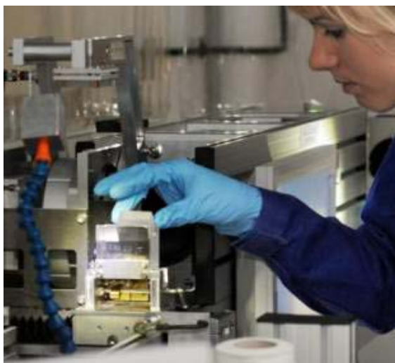
Abb. 2 V-Blockmessung an einem Probenriegel mit bis zu 10 Proben inklusive einer Referenzprobe um Genauigkeiten < 2 \cdot 10^{-5} zu erreichen.
