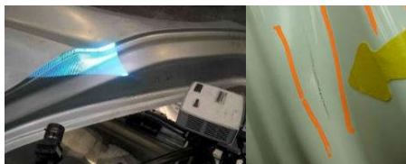
Fig. 1 Anwendungsgebiet Automobilbau: Inspektion Seitenrahmen: Links: Platzierung Messsystem. Rechts: Beispiel Einschnürung
