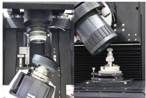
Abb. 1 Beim MSI 300 (links) befindet sich der Prüfling auf einer kippbaren, höhenverstellbaren Rotationsachse, während der Sensor (oben) in x und y verschoben werden kann. Beim MSI 50 (rechts) wird der Sensor gekippt und kann in der Höhe verschoben werden, während sich der Prüfling auf einer Rotationsachse befindet die in x und y bewegt werden kann.
