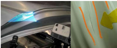
Abb. 1 Anwendungsgebiet Automobilbau: Inspektion Seitenrahmen: Links: Platzierung Messsystem. Rechts: Beispiel Einschnürung. (siehe [3])
