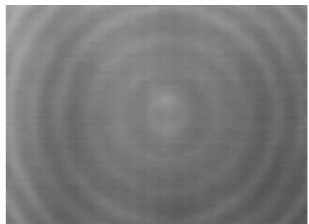
Abbildung 3 Kontrastverstärkte Bildhelligkeitsverteilung einer welligen, asphärischen Feldlinse
