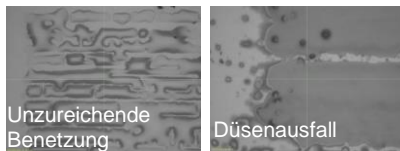
Abb. 4 Beispielhafte Druckfehler; Unzureichende Benetzung innerhalb einer Schicht (links); Düsenausfall des Drucksystems (rechts).
