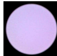
Fig. 4 Erzielte gleichmäßige Lichtverteilung in der Austrittspupille
