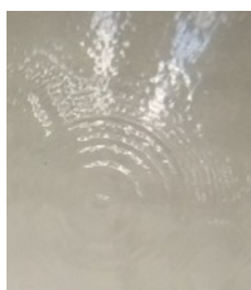
Abbildung 1 Oberfläche einer mittels herkömmlicher additiver Fertigung hergestellte Linse. Eine Schichtstruktur ist klar erkennbar.
