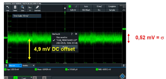
Abb. 6 Oszilloskop-Bild der Spannung V_{out} mit deutlich reduzierter Rauschspannung für R_1 = 500 \text{ M}\Omega .
