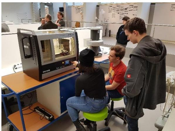
**Fig. 3** Mit Hilfe von Vollschutz-Schulröntgengeräten und Speicherfolien können einfache Durchleuchtungs-aufnahmen durchgeführt werden. (Bildquelle: Deutsches Röntgen-Museum)
