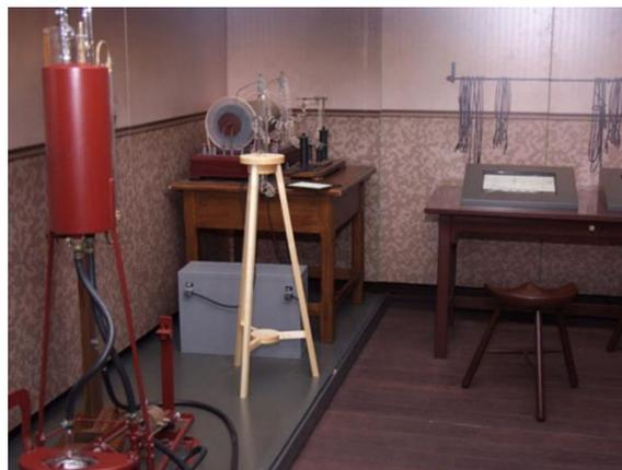
**Abb. 6** Nachbau von Laborgeräten (Funkeninduktor, Batterie, Ionenröhre, Vakuumpumpe, Leuchtkristalle) aus Röntgens Labor. (Bildquelle: DRM)
